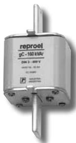
Fusibles tipo NH clase gC adecuados para la protección de capacitores. Están diseñados especialmente para soportar la circulación de sobrecorrientes ricas en armónicas sin envejecimiento y poseen capacidad de ruptura adecuada para la interrupción con contratensión sobre bornes del capacitor.
